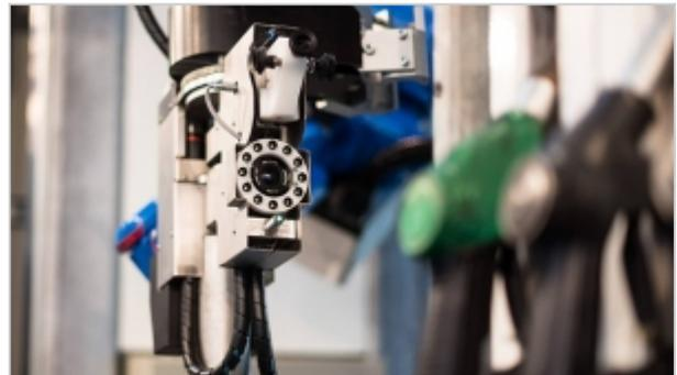
La automatización finalmente ha llegado a las bombas de repostaje: un brazo robótico introducirá la boquilla en el tanque sin necesidad de ayuda. El primer proyecto piloto de este tipo se lleva a cabo en una planta de Neste en Siltamäki, Vantaa, Finlandia, que ya lleva funcionando seis meses.
